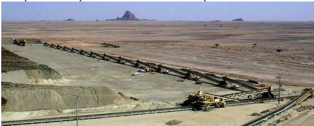
Рисунок 2 – Схема использования короткозвенных мобильных конвейеров
